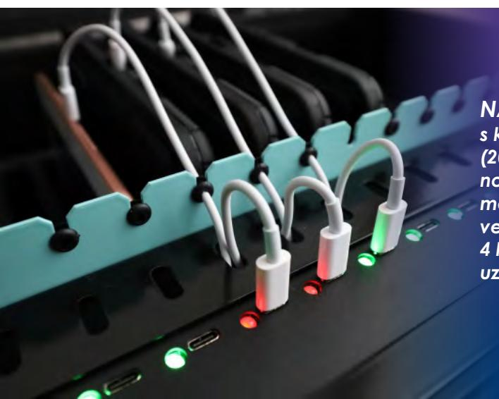
**NABÍJACIE SKRINKY** s kapacitou 32 tabletov (20W/USB) alebo 36 notebookov (60W/USB) majú integrovaný ventilačný systém, 4 kolieska a sú uzamykateľné zámkom.
