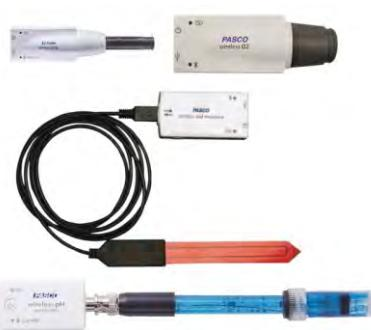
Využijete aj sadu bezdrôtových senzorov (senzory CO<sub>2</sub>, O<sub>2</sub>, pH kvapalín a pôdy, vlhkosti pôdy, kolorimeter a turbidimeter), zmeníte svoje analógové poznatky na digitálne výsledky, stačí Vám k tomu len Vás mobil a softvér SPARKvue.
