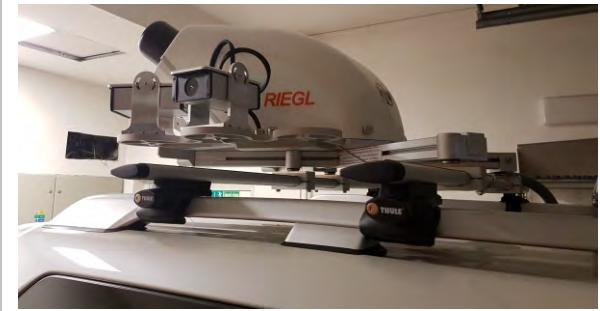
Ako integrátor dopravných riešení sme schopní navrhnuť a implementovať mobilné meracie systémy za použitia najmodernejších zariadení používaných v tejto oblasti (lidar, skenery, kamerové systémy). Zariadenie slúži na digitalizáciu vozovky a jej okolia.
