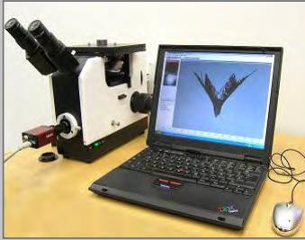
Systém MicroFocuScan (MFS) slúži na rekonštrukciu trojrozmerného modelu povrchu telies snímaných pomocou mikroskopu. Dokáže vytvoriť model povrchu spolu s farebnou textúrou povrchu. Namerané dátá je možné ďalej spracovavať a zobraziť v 3D zobrazení.
