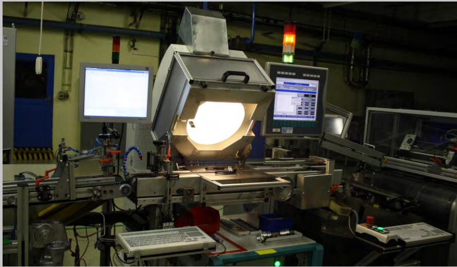
Aplikácia pracuje na princípe porovnávania zosnímaného obrazu kontrolovaného ložiska s jeho etalonom. Program pracuje v reálnom čase, využíva korelačné algoritmy a je vhodný pre nasadenie priamo do výrobnej linky.
