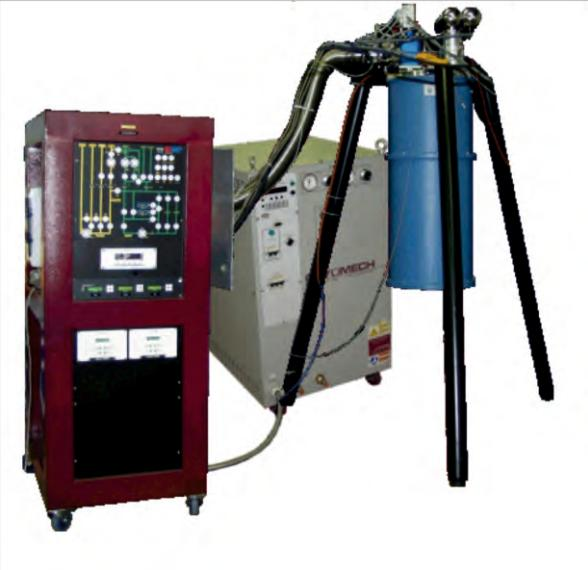
Zariadenie umožňuje vykonávať experimenty pri extrémne nízkych teplotách blízko absolútnej nuly. Tieto podmienky sa využívajú na štúdium kvantových javov. Laboratórium je vybavené meracou technikou a analyzátormi elektrických signálov na hranici možností súčasných technológií.
